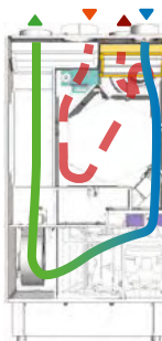
Flusso free cooling
