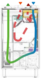
Flusso free cooling
