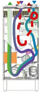
Flusso ricircolo, ricambio e trattamento aria
