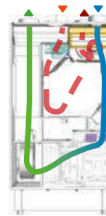
Flusso free cooling
