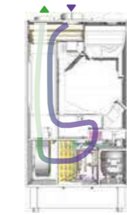
Flusso ricircolo e trattamento aria
