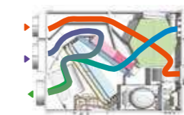
Flusso ricircolo, ricambio e trattamento aria
