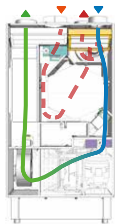
Flusso free cooling
