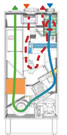
Flusso free cooling
