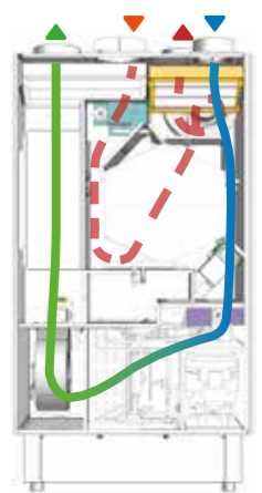
Flusso free cooling
