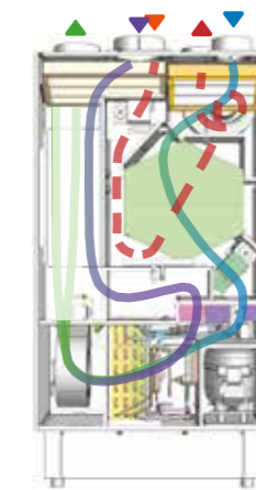
Flusso ricircolo, ricambio e trattamento aria
