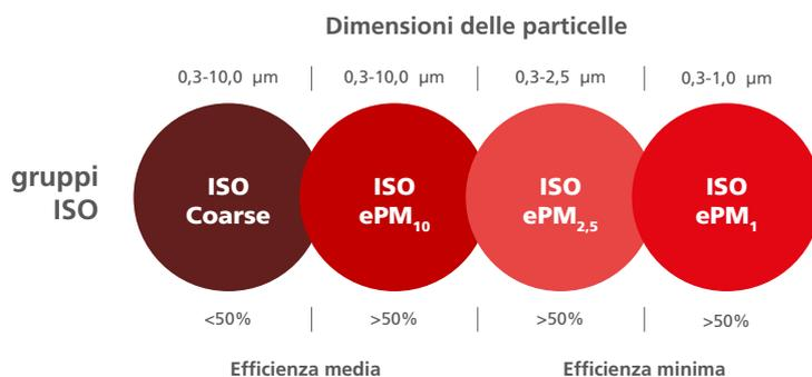
La filtrazione delle particelle più pericolose per la salute umana, e cioè le più sottili  $PM_{1}$  e  $PM_{2,5}$ , è possibile grazie ad un filtro ad elevate prestazioni, ISO ePM<sub>1</sub> 55%. A seconda della versione di macchina per il trattamento aria il filtro può essere contenuto in uno specifico box filtro oppure alloggiato direttamente all'interno della macchina.
