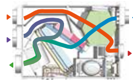
Flusso ricircolo, ricambio e trattamento aria
