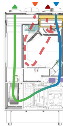
Flusso free cooling
