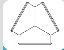
Derivazione a Y senza riduzione
